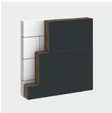
Anwendung hinterlüftete Fassade.
